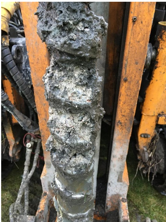
Figur 7 Skrubborr med prov från söndervittrad betongplatta.
