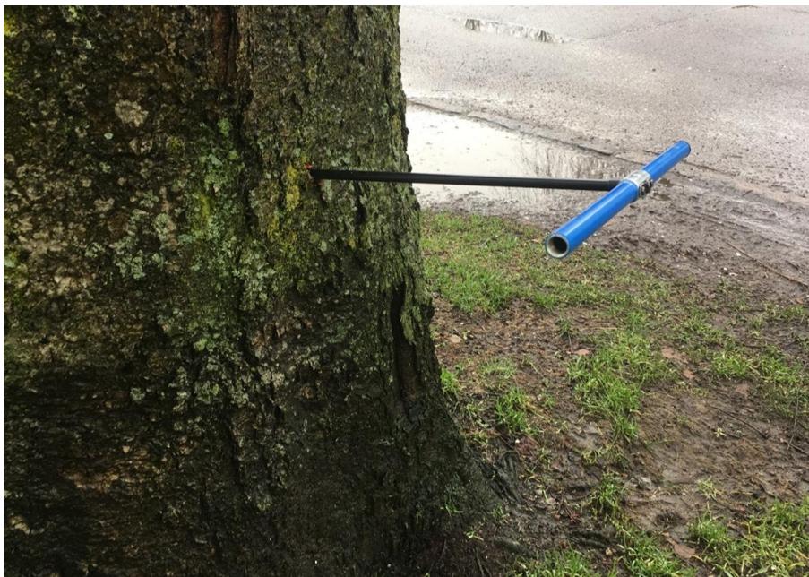
Figur 6 Provtagning av träd med hjälp av tillväxtborr.
